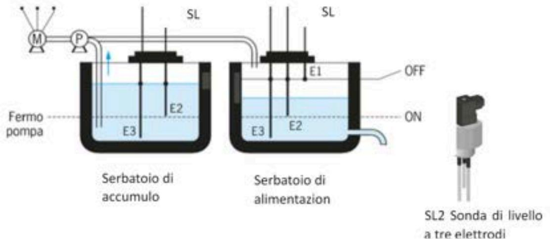
Il regolatore di livello rileva le due correnti controllando tra quali elettrodi esse circolano, e comanda il suo contatto di uscita SL2 solo quando entrambe le coppie passano da uno stato di conduzione a uno di non conduzione o viceversa, realizzando quindi la marcia o l'arresto dell'elettropompa.
